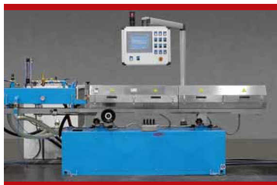
Forno di preriscaldamento Pre-heating oven
